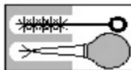
2. Очистите внутреннюю поверхность отверстия с помощью воздушного насоса и щетки.
