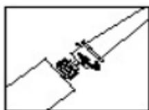
3. Установите смесительную насадку на картридж (Завинтите и затяните потуже)
